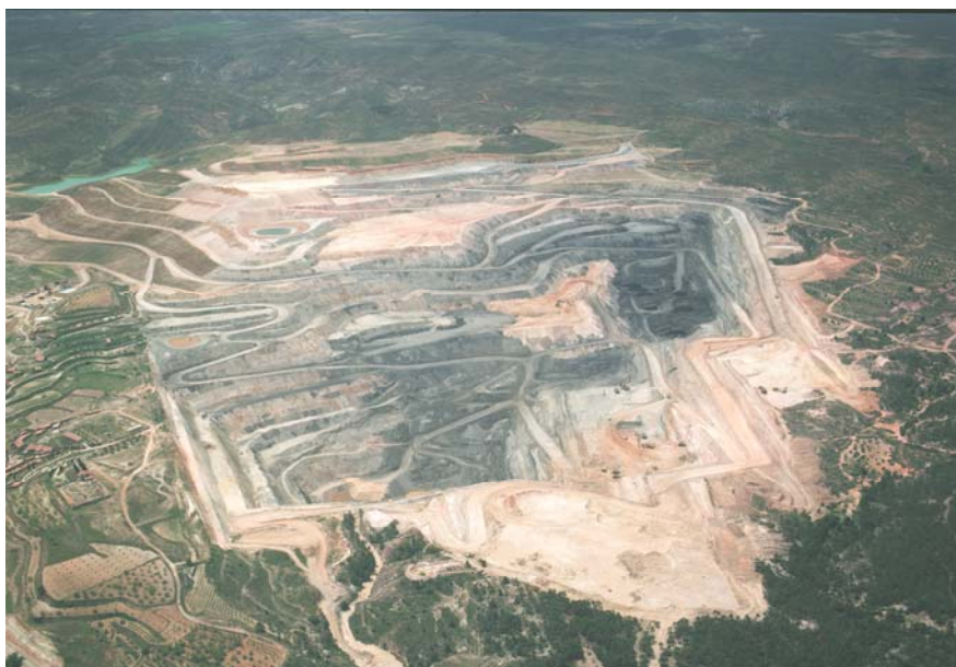
Fig. 5.42.- Vista aérea de la Corta Gargallo Oeste, en Estercuel. Al fondo taludes de escombrera remodelados y revegetados (Foto: ENDESA GENERACIÓN, S.A.)
