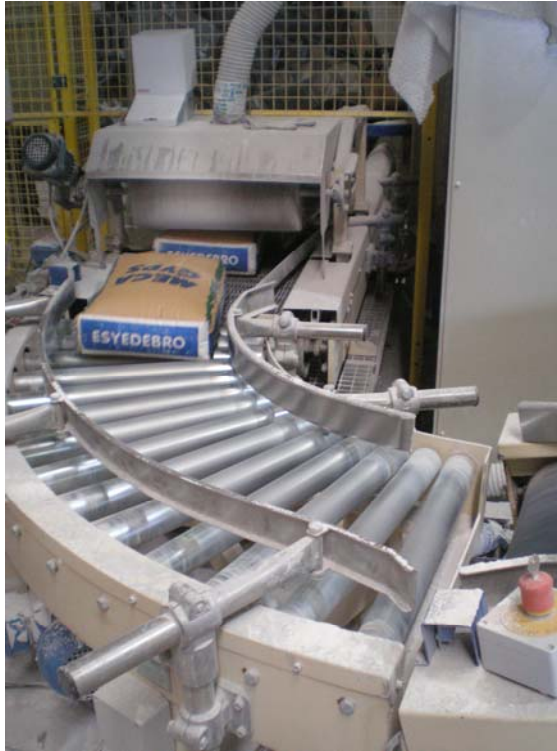
Figura 4.4.- Línea de ensacado automático. ESYEDEBRO, S.L.
