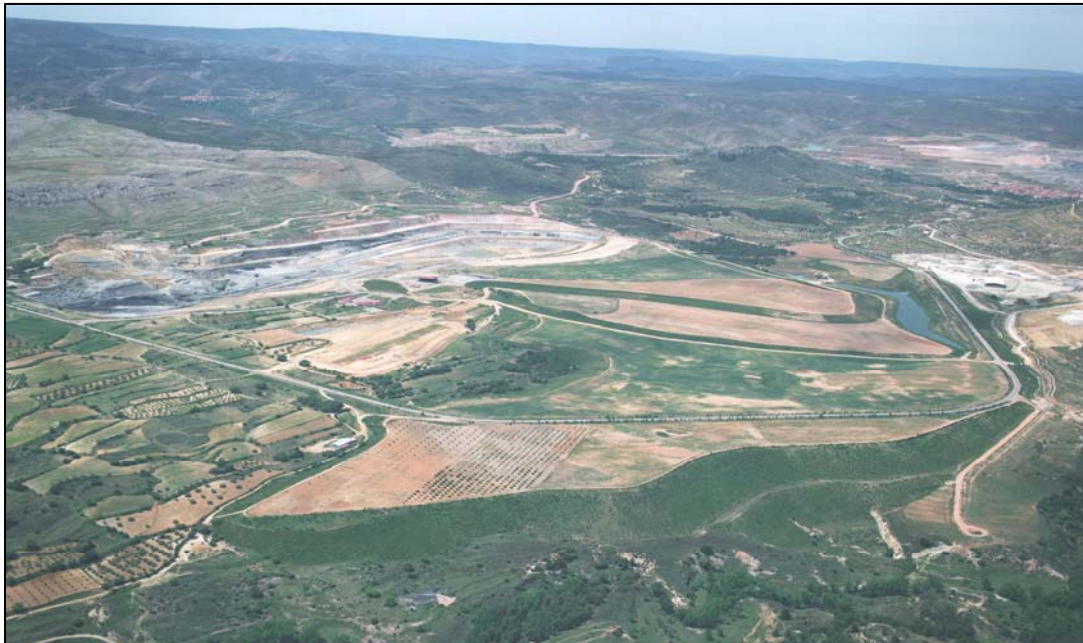
Fig. 5.40.- Corta Gargallo: Modelo de restauración plataforma-talud ecológico (Esta página: aspecto reciente. Página siguiente: Evolución del avance de la restauración) (Fotos: ENDESA GENERACIÓN, S.A.)
