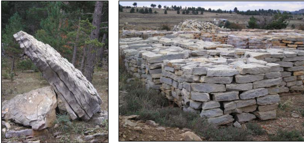
Fig. 4.17.- Roca caliza tableada y lajas de tipología gruesa, ya elaboradas. Mosqueruela (Teruel)
