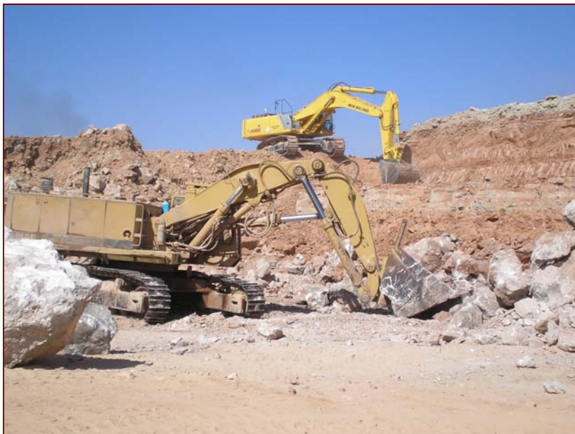
Fig. 3.17.- Labores de arranque del alabastro. ARASTONE, S.L.
