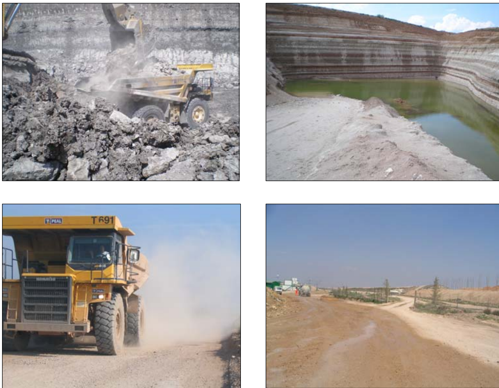
Fig. 5.11.- Fuentes generadoras de polvo, gestión del agua y riego de pistas
