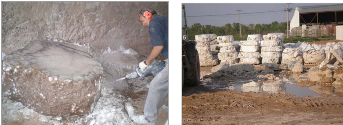
Fig. 4.18.- Eliminación de material no utilizable (izq.). Rodajas de alabastro listas para talla o comercialización (dcha.). Planta de ARASTONE, S.A. en Gelsa de Ebro (Zaragoza)
