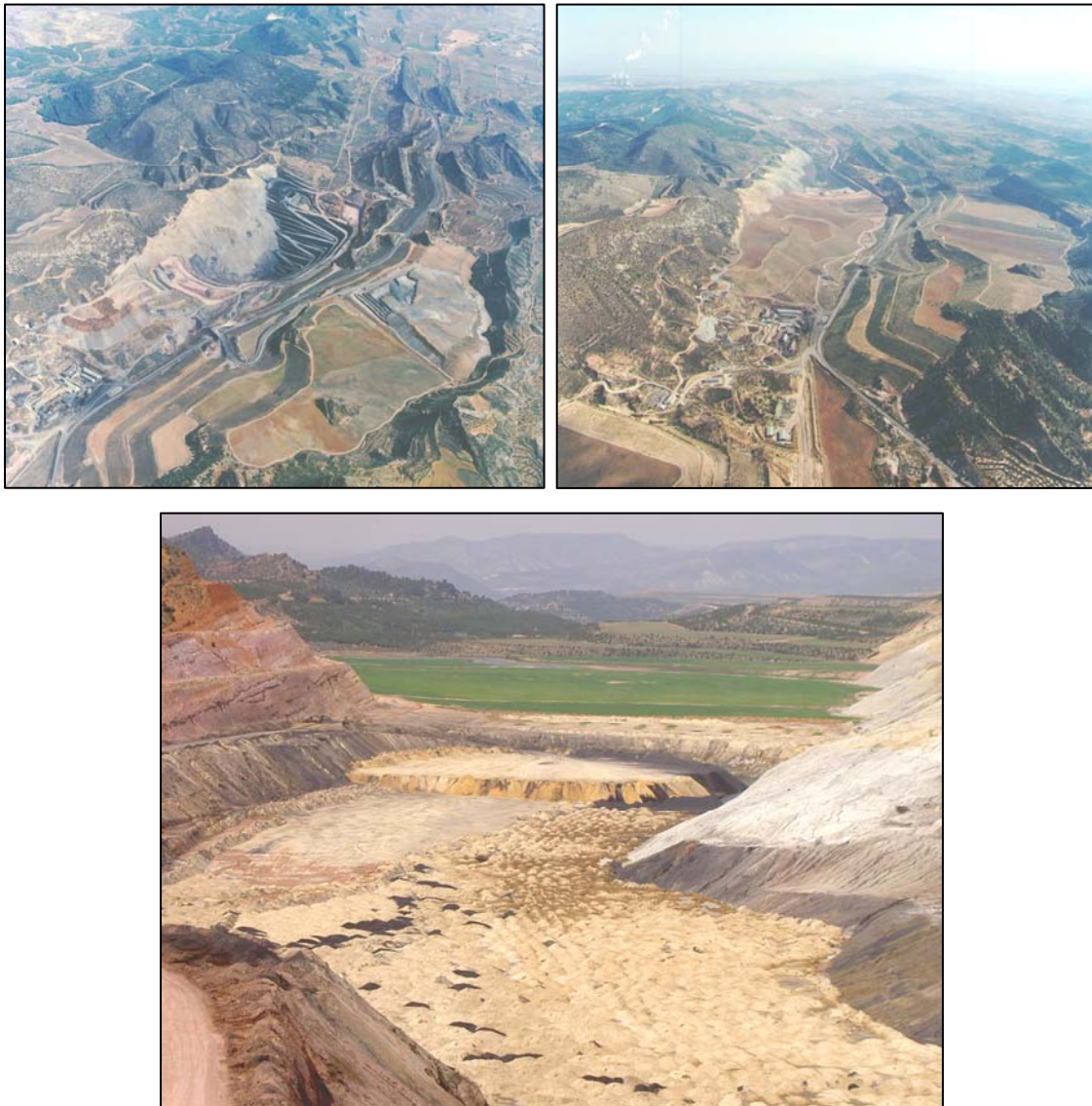
Fig. 5.38.- Vistas aéreas. Arriba: Fases del avance de la explotación y restauración en Corta Barrabasa. Abajo: Relleno del hueco final de la misma (Fotos: ENDESA GENERACIÓN, S.A.)
