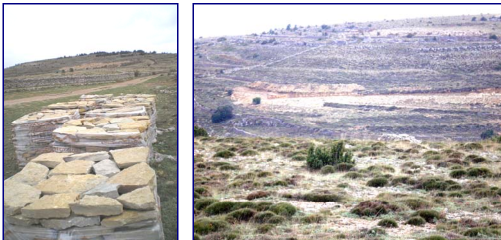
Fig. 3.20. Lajas de la provincia de Teruel (Mosqueruela). Izquierda: Lajas preparadas. Derecha: Frentes de explotación en ladera.
