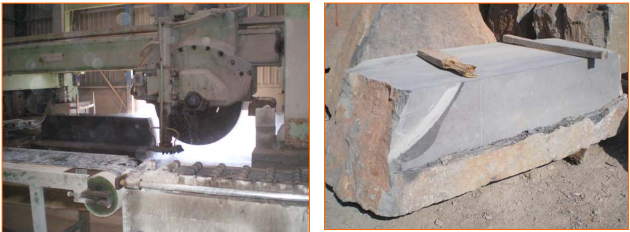
Fig.4.18. bis - Disco para corte de roca ornamental y bloque de caliza marmórea negra de Calatorao (Zaragoza). PYMCASA, S.A.
